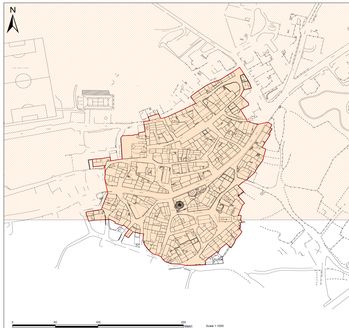
Figura 6 – Elaborato MT1104-D-01EG-1GTAV-A allegato allo “Studio di Compatibilità Idraulica, Geologica e Geotecnica” approvato Delibera n. 10 del 19.06.2018, raffigurante la pericolosità da frana nel centro abitato di Tadasuni.
